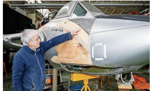
Heinz Bärffuss begutachtet eine bereits mit Kunststoff und Sperrholz reparierte Stelle an der Vampire.
